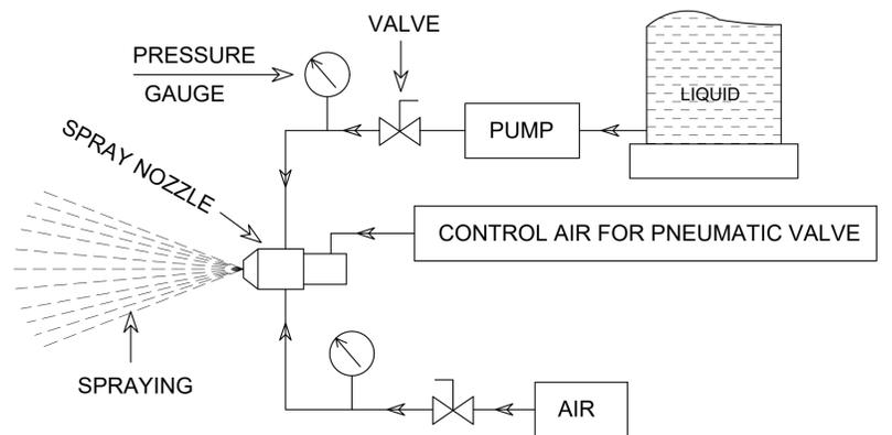
CYLINDER OPERATED AIR ATOMIZING NOZZLES
